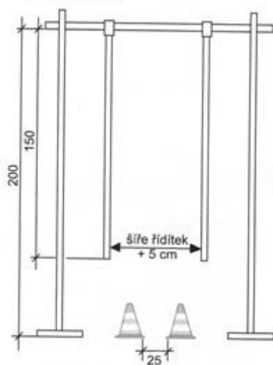
Překážka má dvě části. Vlastní branka je vysoká 200 cm a široká 150 cm; z břevna jsou spuštěna dvě pohyblivá ramena (tyčky), vzdálená od sebe na délku rozpětí řídítka používaných jízdních kol, zvětšenou o +5 cm. Na zemi v profilu branky jsou dva kužele ve výši 18 cm vzdálené od sebe 25 cm (světlost průjezdu). Soutěžící se nesmí dotknout žádné části překážky ani vyjet z vymezené dráhy.
