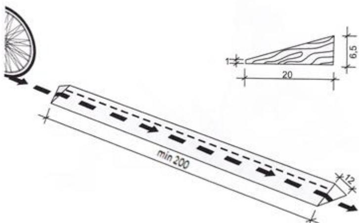
Prkno je dlouhé min 200 cm a široké 20 cm, s upraveným nájezdem a výjezdem. Zešikmení prkna v profilu kola je 30 stupňů. Prkno se ve směru jízdy svažuje vpravo. Sjetí z prkna oběma koly před jeho polovinou je hodnoceno jako vynechání větší části překážky.
