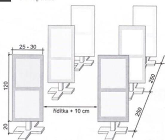
Překážku tvoří 120 cm vysoké a 25 až 30 cm široké otočné rámy (deska s otvory) na 20 cm podstavci, které jsou umístěny vedle sebe ve vzdálenosti řídítka + 10 cm, tři páry za sebou se vzájemným rozestupem 250 cm. Soutěžící se nesmí dotknout rámu ani vyjet z vymezené dráhy.
