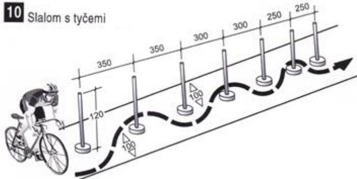
Soutěžící postupně objízdí 7 slalomových tyčí vzdálených od sebe  $2 \times 350$  cm,  $2 \times 300$  cm a  $2 \times 250$  cm ve vyznačené dráze široké 200 cm. Slalomové tyče jsou vysoké 120 cm (na zemi podstavec o průměru 15 cm). Cyklista se nesmí dotknout slalomové tyče, vynechat objetí tyče. Neobjetí tyče je hodnoceno jako vynechání větší části překážky.
